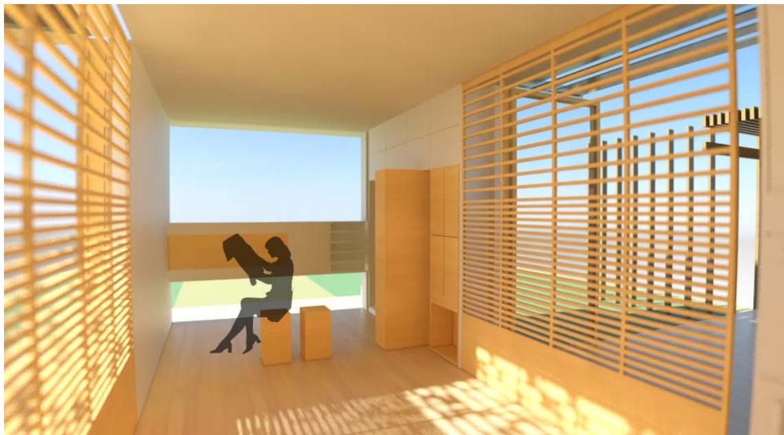
Figure 30 Vue intérieure, parois mobiles à latte pivotantes
