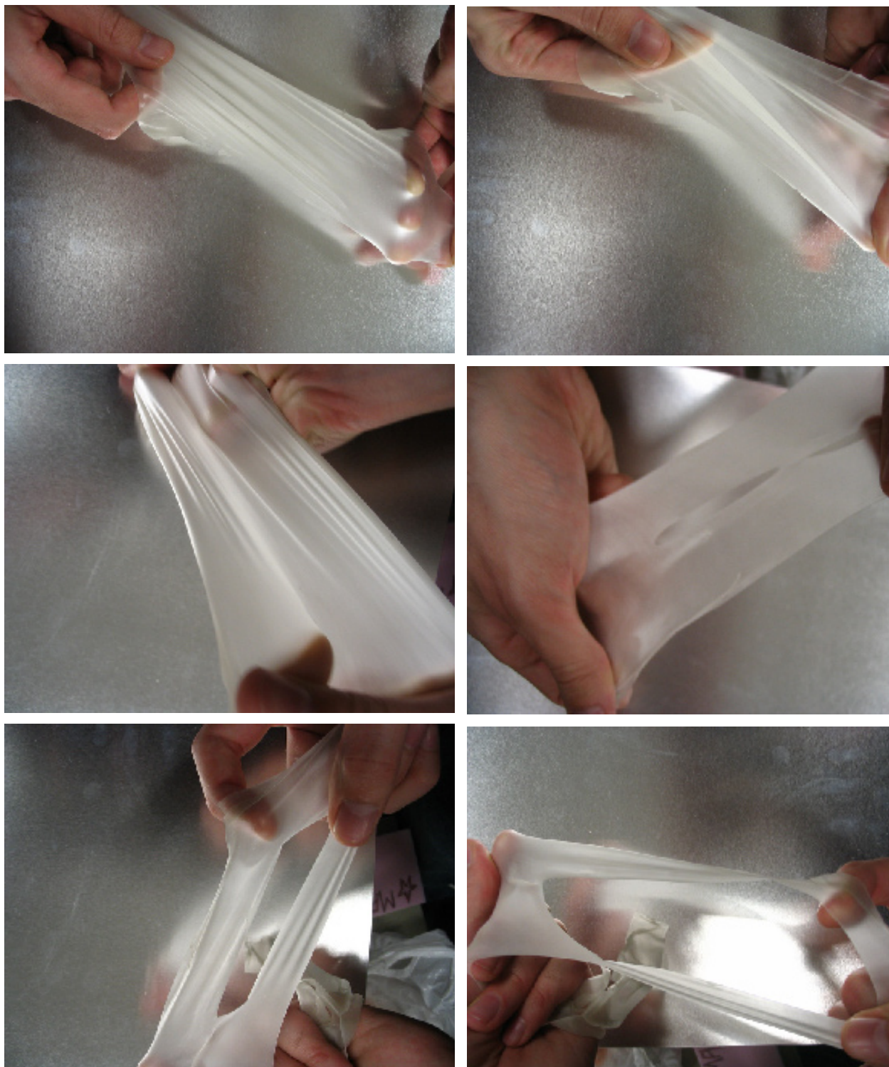
Figure 19 : Étude du comportement élastique d'une membrane d'acrylique
