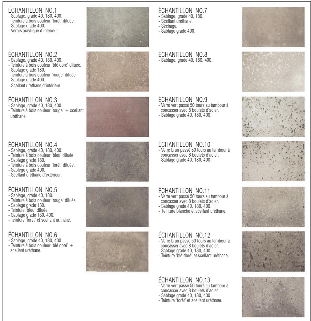
Figure 7.15 Surfaces obtenues par finition de la surface horizontale d'un coulé de béton brut avec agrégats divers
