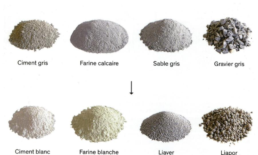
Fig. 39: En haut, composition usuelle du béton. En bas, la composition du béton choisie pour sa couleur blanche par Olgiati pour le Musée du parc national suisse de Zerne. Comme pour ce projet, il a utilisé sa propre composition de béton pour obtenir la teinte rouge-brun du béton de l'Atelier Bardill. Source: OLGATI, Valerio. Olgiati: Une Conférence de Valerio Olgiati, Bâle, Birkhauser, 2011.
