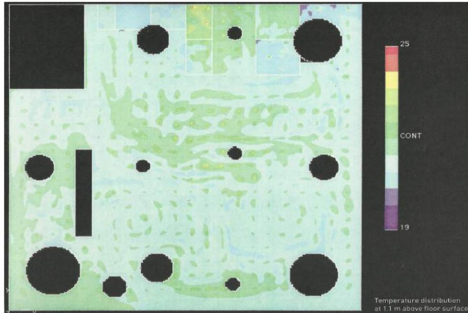
Distribution des température sur la surface de plancher [Ito, 2003, p. 93]
