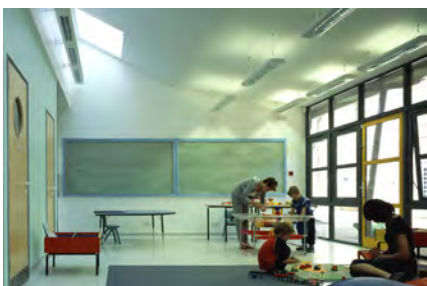
Figure 22: Exemple d'éclairage naturel contrôlé avec éclairage d'appoint artificiel, Netley School Autistic Resource Base (source: http://www.archdaily.com )
