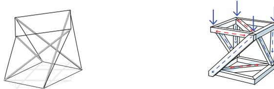
Figure 6: Principe structural s'inspirant de la «tenségrité»
