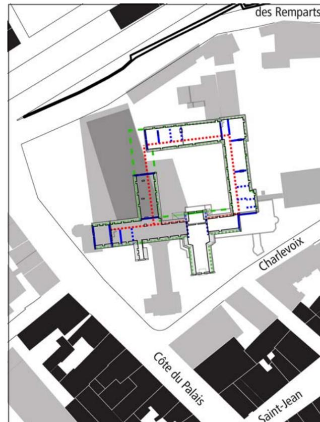
Figure 4.14a : Composition structurale des murs porteurs, 1848, étage des fondations (niveau 00)
