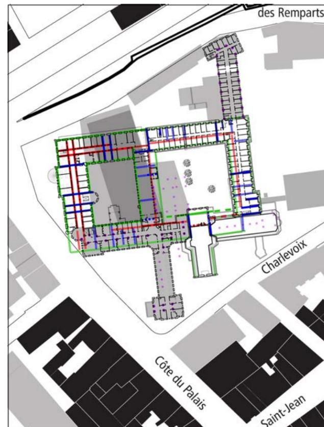
Figure 4.16a : Composition structurale des murs porteurs, 1953, étage des fondations (niveau 00)
